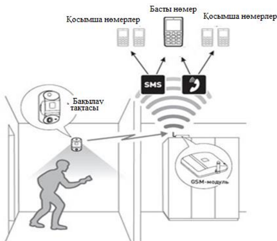
Сурет 1 – GSM-дабылынының жұмыс атқару қағидасы
