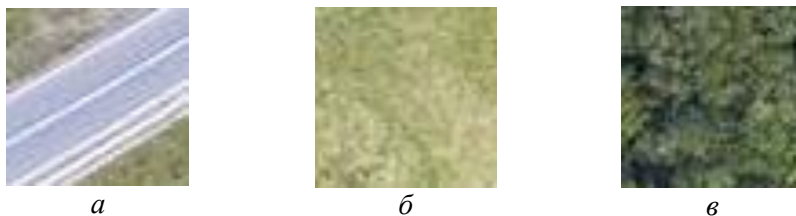
Рисунок 1 – Кадри зображення регіону: a – автомагістраль (клас розпізнавання X_1^o ); b – чагарник (клас розпізнавання X_2^o ); v – рідкий ліс (клас розпізнавання X_3^o )
